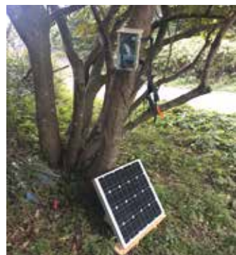
開発中のセンサー。ソーラーパネルの電源を使用
