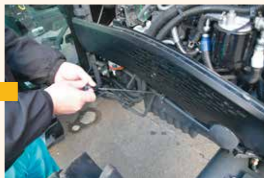
検油ゲージでオイルの量、汚れをチェック
