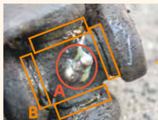
グリスニップルからA(中央)にグリスを注入し続けて、B(4か所の隙間)からグリスが滲み出てくれば完了です
