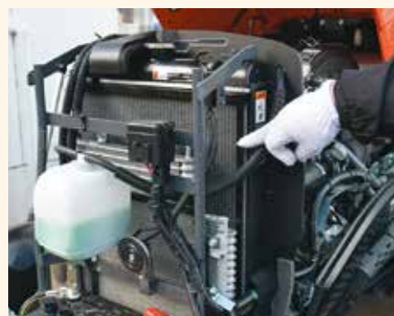
フィルターの掃除は定期的に行いましょう。エンジンの出力低下などの原因になります
