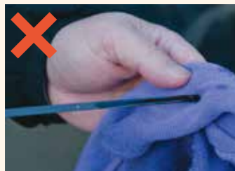
オイルが汚れている
