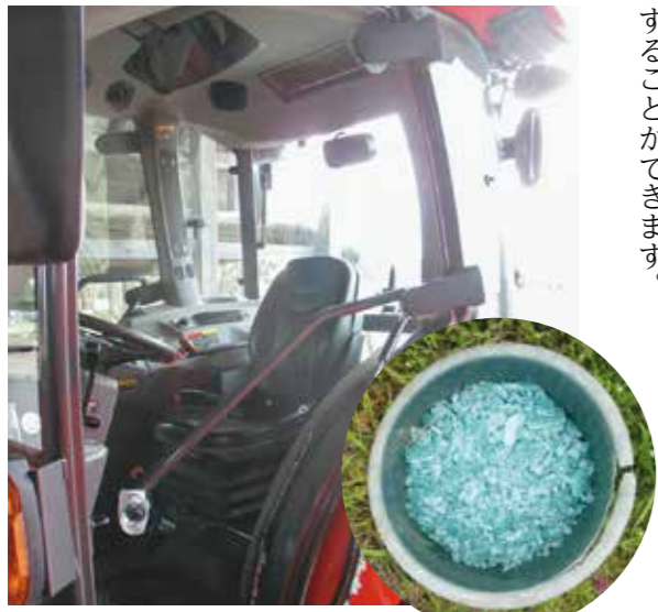
トラクターを農作業場へ格納する際にキャビンガラスを破損
